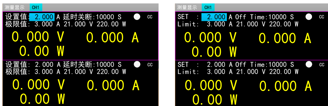
图 2.4.1 定电流测量模式
