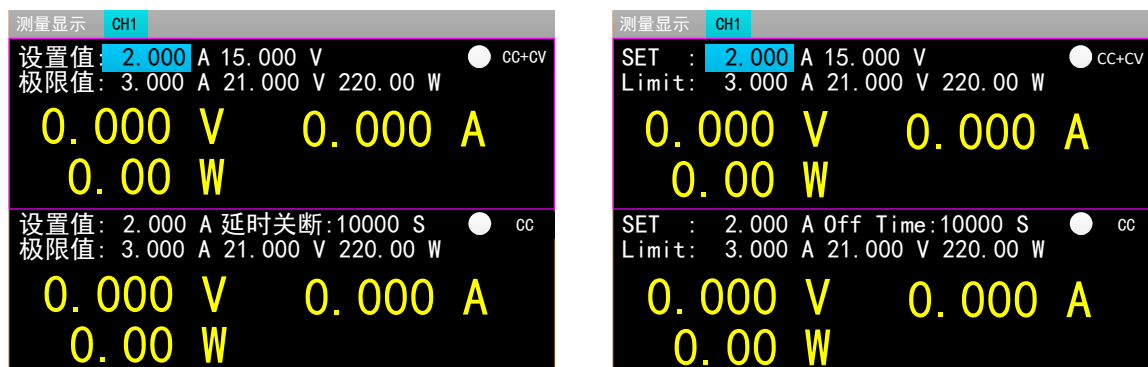
图 2.4.5 定电流转定电压测量模式
