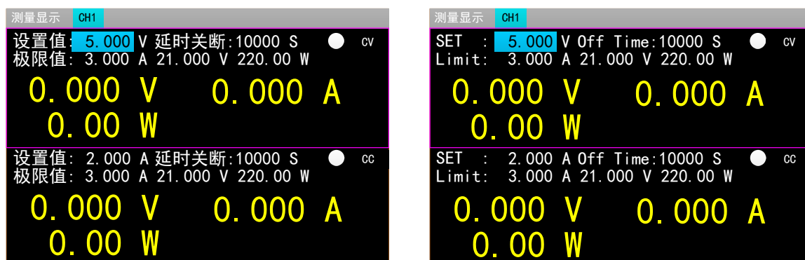
图 2.4.2 定电压测量模式
