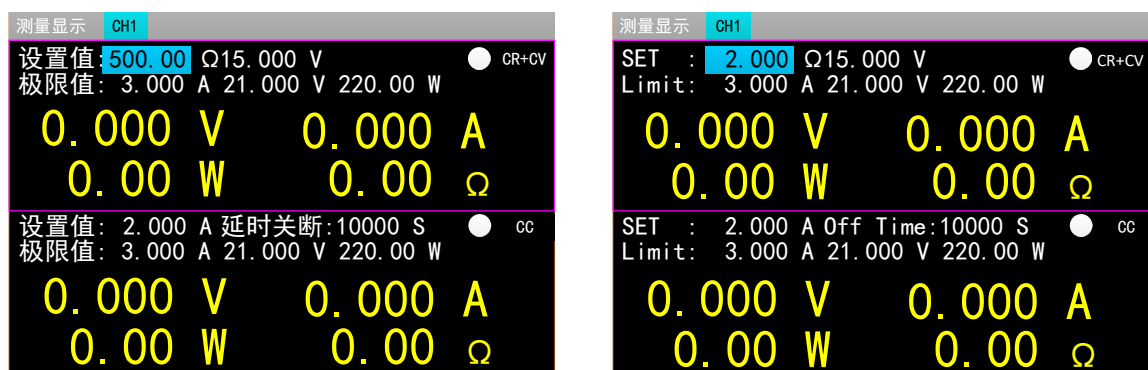
图 2.4.5 定电阻转定电压测量模式
